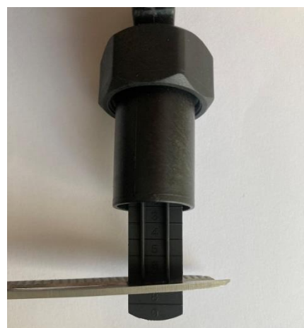
3. Coupez la palette à 40-60 % du diamètre intérieur du tuyau : \varnothing 50 mm environ 20 mm, \varnothing 63 mm environ 25-30 mm, \varnothing 75 mm environ 30-35 mm.
